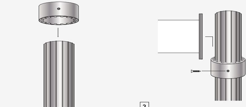
**1** Unterstes Ringprofil (50 mm Höhe) auf das Profil stecken.
