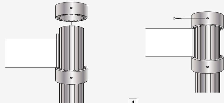
**3** Aufstecken des oberen Ringprofils (50 mm Höhe als oberstes Abschlussringprofil, oder 70 mm als Zwischenringprofil) und Einführen des Klemmprofils in eine der 15 Nuten (an Schraubenposition nicht möglich).
