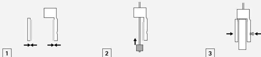
**1** Schaumgummi zum Schutz der Glasscheiben auf die Innenseite der Klemmstücke kleben. Auf richtige Positionierung achten: Aussparung für Schraube berücksichtigen.
